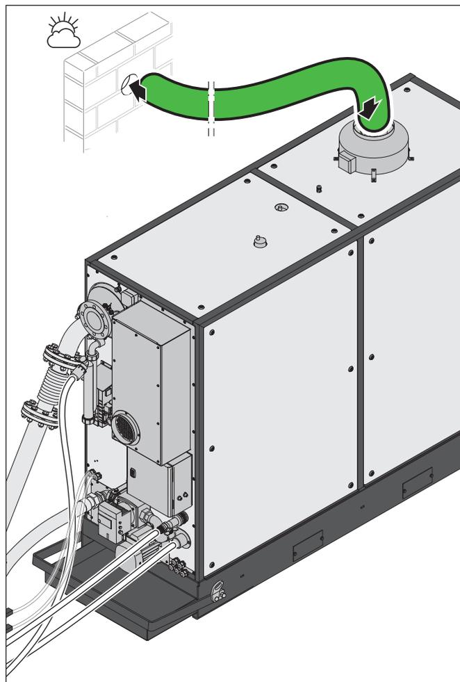
La tubazione (ad es. tubo flessibile in alluminio) deve poter essere collegato e smontato in modo flessibile per l'esecuzione dei manutenzione.
