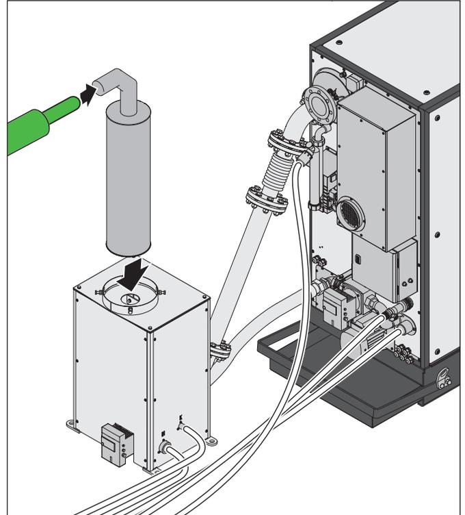
La tubazione deve essere condotta fino allo scambiatore di calore del gas di scarico a condensazione con un'adeguata pendenza.
