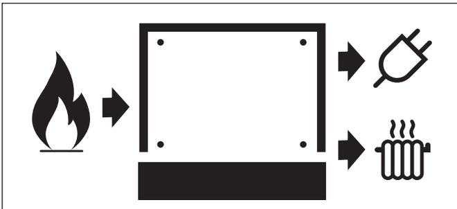
L'unità di controllo regola e controlla il processo di combustione all'interno dell'unità di generazione. L'azionamento avviene tramite il display di comando sull'armadio di comando.
