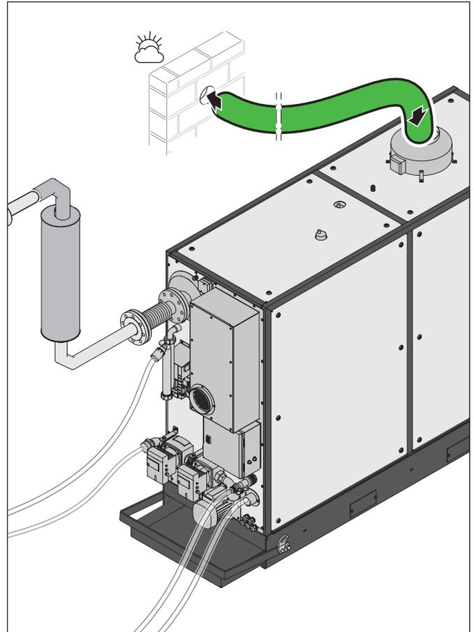
La tubazione (ad es. tubo flessibile in alluminio) deve poter essere collegato e smontato in modo flessibile per l'esecuzione dei manuttenzioni.
