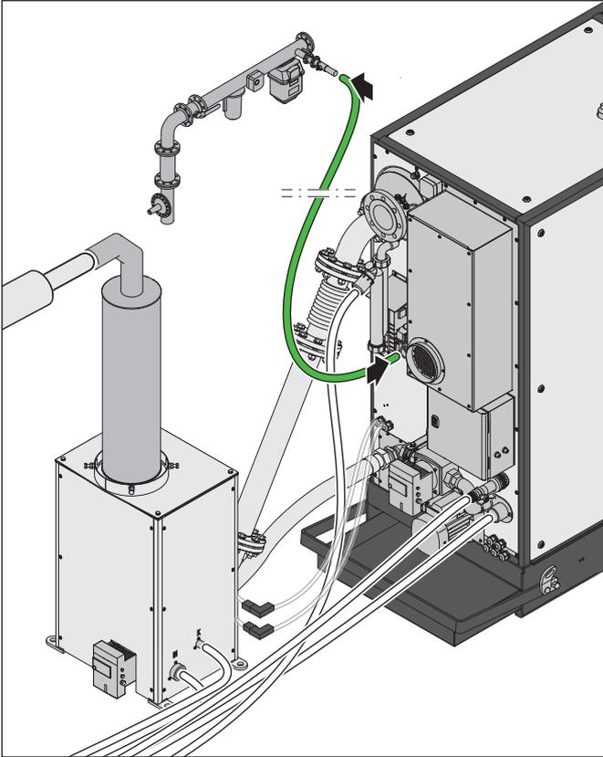
Per l'allacciamento del gas osservare alle normative vigenti (ad es. in Germania secondo le regole tecniche per l'installazione del gas (TRGI)). L'allacciamento tramite un raccordo a innesto per apparecchi a gas non è consentito.
