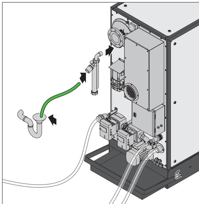
La tubazione dell'acqua di condensa deve essere resistente alla corrosione.
