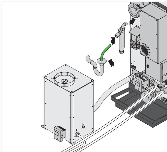
La tubazione dell'acqua di condensa deve essere resistente alla corrosione.
