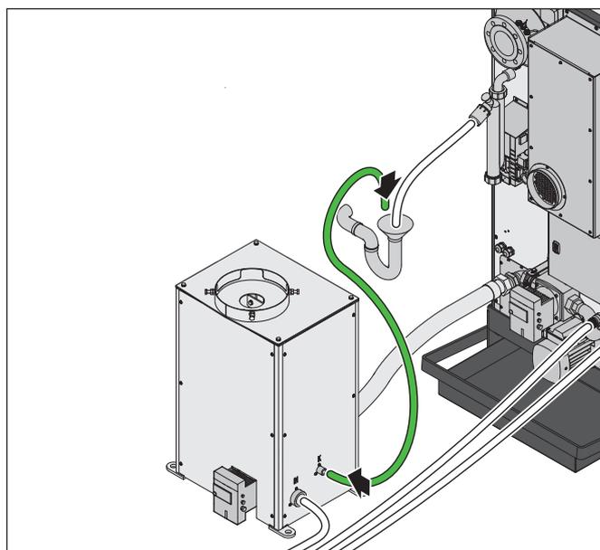
La tubazione deve essere condotta dallo scambiatore di calore del gas di scarico a condensazione fino allo scarico con un'adeguata pendenza.
