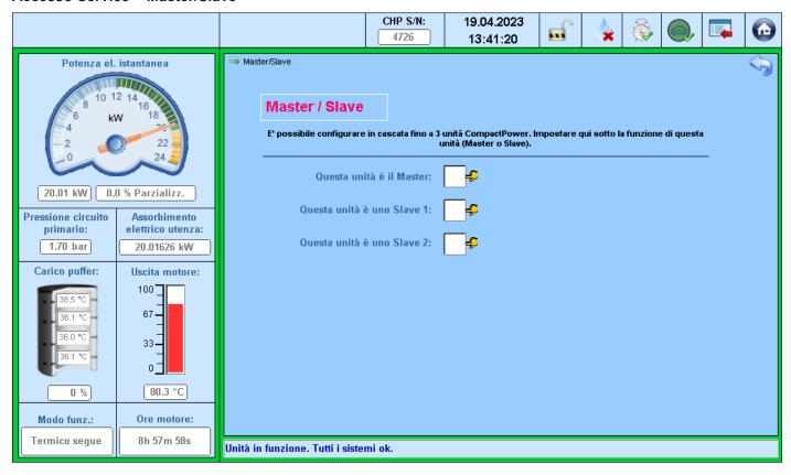
In caso di installazione di due o tre impianti, possibile commutare gli impianti in cascata. In modalità cascata, gli impianti interessati sono definiti come unità "Master" o "Slave". Il "Master" assume il controllo di tutti gli impianti collegati. Esempio:
