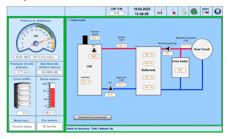
La pagina iniziale mostra una panoramica dell'impianto controllato in base allo schema idraulico (la struttura reale potrebbe essere diversa).
