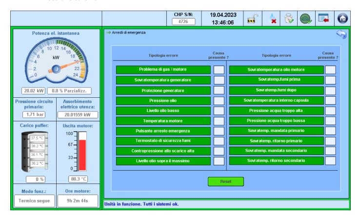
L'impianto controlla costantemente varie temperature e condizioni. Se durante tale controllo vien rilevato il superamento di determinati valori limite, automaticamente viene eseguito un arresto di sicurezza. Le possibili cause dell'arresto di sicurezza vengono visualizzate su questa schermata. I rispettivi messaggi hanno lo sfondo verde.
