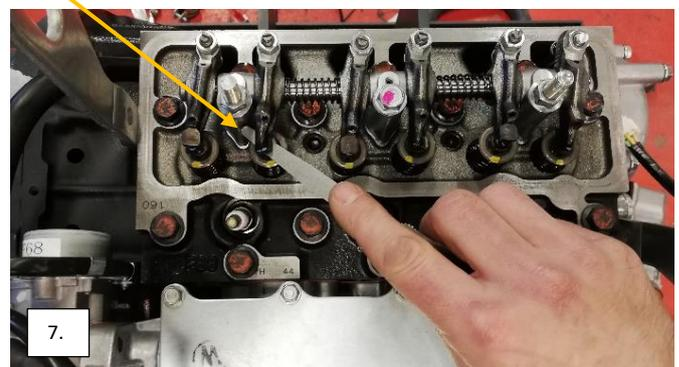
9. Nach dem 1. Zylinder folgen die Zylinder 2. und 3. mit in demselben Vorgang wie es ab Punkt 5 beschrieben ist. Zum Schluss wird das Ventilspiel noch einmal kontrolliert und die Ventilspiele im Wartungsplan dokumentieren!
